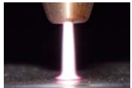
Vorzug des Plasmaschweißens: ein schmaler, gut konturierter Lichtbogen
