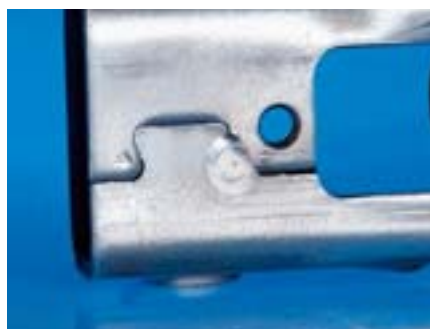
Sicherungspunkt an Omega-Verschlüssen, plasmageschweißt trotz verölter Oberfläche
