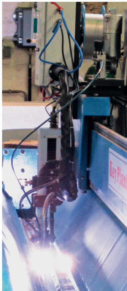
Groß im Kommen: Das Fügen von Blechen nach dem Plasma-Stichloch-Verfahren
