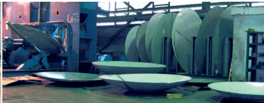
Schritt für Schritt: Fügen nach dem Plasma-Stichloch-Verfahren (links) und Formen mit der Presse im Bödenpresswerk Daaden
