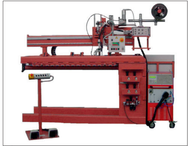
Charakteristisch: 2-m-Längsnaht-Schweißanlage für das Plasma-Stichlochsweißen von Rohren und Blechen mit einer »MIG-O-MAT plasmaJET 350SPS-K« als Aufbau
